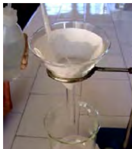
Fig. 1. Instalația de filtrare la presiune atmosferică
