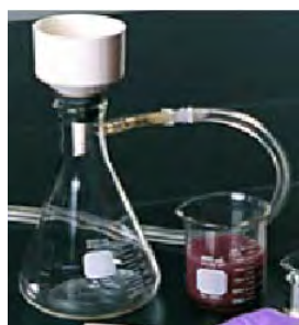
Fig. 3. Instalația de filtrare în vid
